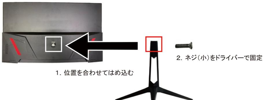
③スタンドを取り外す場合は、本体背面のスタンド取り付け部のネジを、ドライバーを使用して取り外してください。
